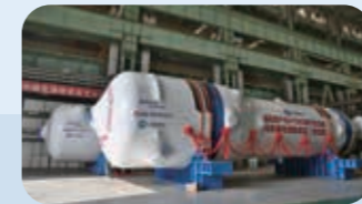
蒸汽发生器 Steam Generator
